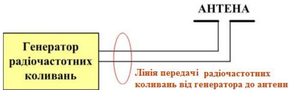
Рисунок 3 – Спрощена схема радіопередавача
