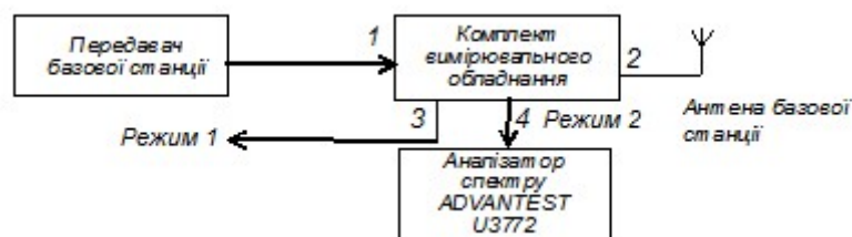
Рисунок 1. - Схема підключення обладнання до базової станції
