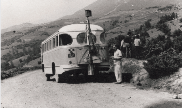
Пересувний пункт технічного радіоконтролю на базі автобуса ПАЗ
